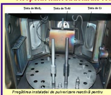
Pregătirea instalației de pulverizare reactivă pentru dezvoltarea acoperirii nanostructurate a axelor mecanice
