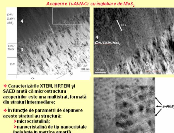
◆ Caracterizările XTEM, HRTEM și SAED arată că microstructura acoperirii este una multistrat, formată din straturi intermedii;
